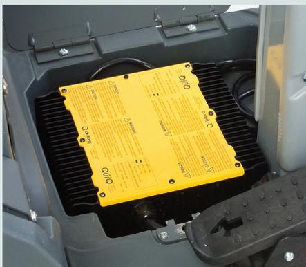
El cargador integrado permite enchufar y cargar la batería en cualquier lado.
