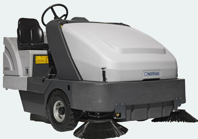
La serie SR 1601 consta de seis modelos con la opción de motor diésel (3 cilindros) o LPG, o de 48 V con batería para uso en exteriores o interiores. Cada variante está disponible con la opción MAXI para incluir una escoba en el lado izquierdo, dirección ajustable y pre-nebulización de serie. La potente acción de limpieza es ideal para la limpieza de áreas de fabricación, estacionamientos, obras en construcción, almacenes, etc.
