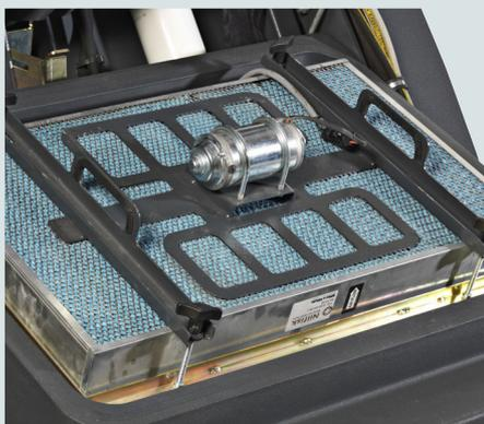
El agitador del filtro patentado como Multispectrum™ previene la acumulación de polvo y obstrucciones para un mejor rendimiento.
