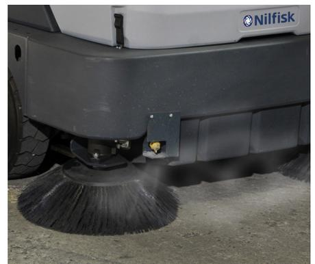
El exclusivo sistema DustGuard™ controla efectivamente el polvo transportado por el aire proporcionando una fina niebla de humedad a los cepillos delanteros y laterales
