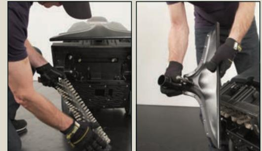
Extraiga el cepillo por el lado izquierdo y límpielo. Para instalarlo de nuevo, conecte primero el lado derecho y luego empuje el lado izquierdo del cepillo hasta colocarlo. Retire la boquilla de aspiración y límpiela.
