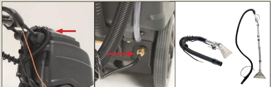
Para instalar los accesorios retire la manguera de aspiración de la tapa y conéctela a la conexión izquierda vacía. Conecte la manguera de aspiración del accesorio y conecte la manguera de solución en el acoplamiento rápido en la parte inferior derecha. Cuando ambos están conectados, asegúrese de que la máquina esté estacionada con el soporte y conecte el interruptor principal de la máquina con botones de la aspiración y de la bomba conectados para trabajar con el accesorio.
