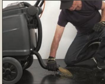
Vacíe el depósito de recuperación utilizando la manguera de vaciado.
