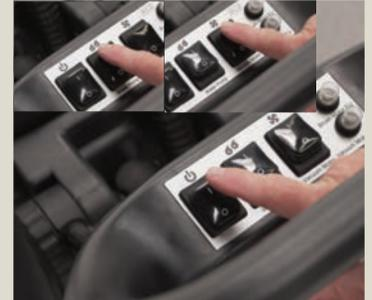
Para poner en marcha la máquina primero conecte la aspiración y la inyección de solución y luego conecte el interruptor principal de la máquina.
