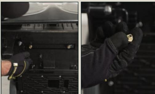
Cuando retire el cepillo, limpie la carcasa del cepillo y, si es necesario, compruebe las dos boquillas pulverizadoras de solución.
