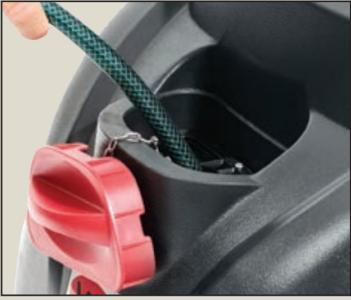
Llene el depósito de solución con agua limpia. Añada un detergente adecuado para la limpieza de moqueta con el método de inyección-extracción.
