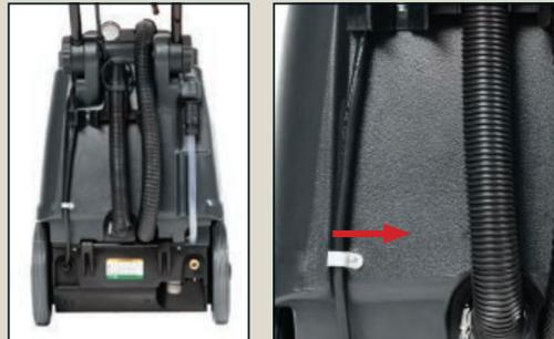
En la parte inferior de la máquina puede acceder al filtro de solución. Mantenga limpio el filtro.
